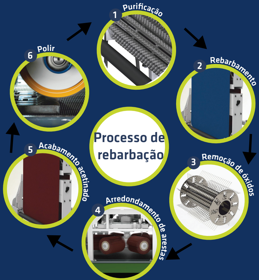
Exemplo de estrutura modular com 3 módulos: 2 Rebarbamento, 4 Arredondamento de arestas e 5 Acabamento acetinado
