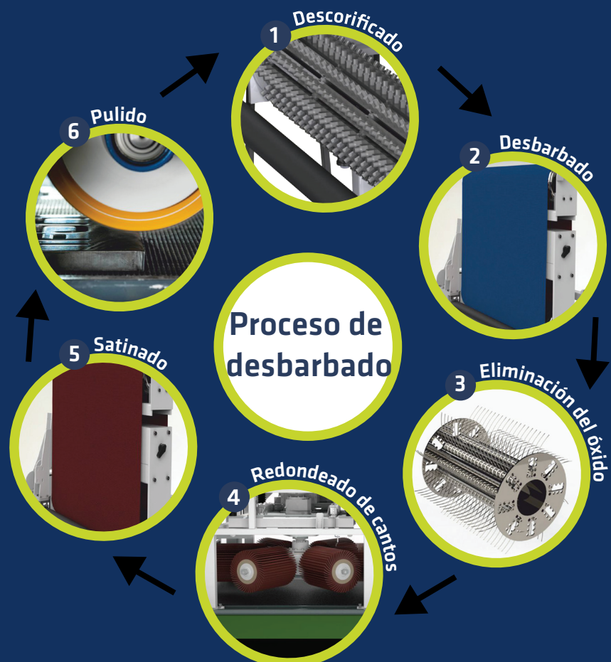
Ejemplo de estructura modular con 3 módulos: 2 desbarbado, 4 Redondeado de cantos y 5 satinado
